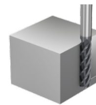
FREZOWANIE WALCOWO-CZOŁOWE Z WYSOKIM POSUWEM
